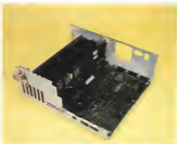
Nel caso dell'Amiga 2000A dovremo togliere il vecchio processore (e montare tre jumper - vedi testo).
